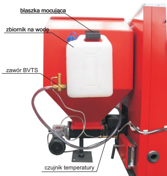
Rys. 7. System gaszenia Strażak ze zbiornikiem zamontowanym na zasobniku.
