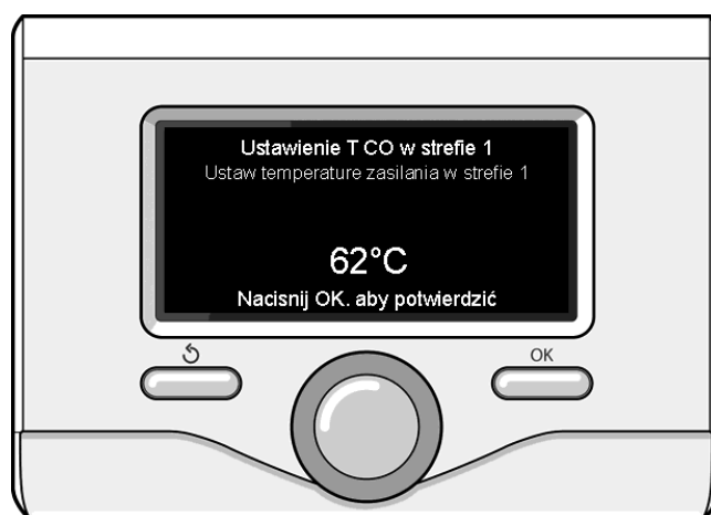
Zmiana temperatury ciepłej wody do ogrzewania
